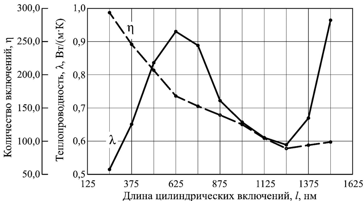
Рисунок 3.8 – Зависимость теплопроводности ( $\lambda$ ) и количества включений ( $\eta$ ) от длины включений ( $l$ ) для хаотически армированных элементарных ячеек с массовой долей наполнителя 0,4%
