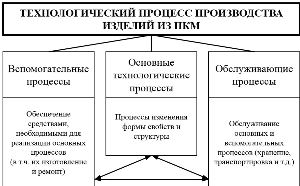
Рисунок 1.11 – Иерархическая система технологического процесса производства изделий из РПКМ
