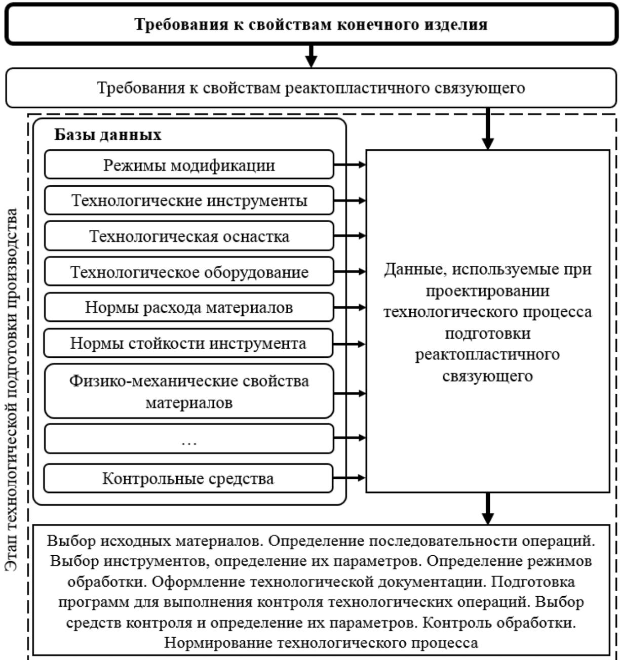
Рисунок 1.14 – Схема информационного потока данных на этапе ТПП изделий из композиционных материалов
